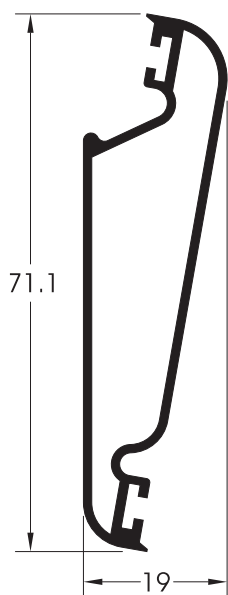
ΚΩΔΙΚΟΣ/CODE ΒΑΡΟΣ/WEIGHT Γ148 544gr/m ΠΕΡΙΓΡΑΦΗ/DESCRIPTION Προφίλ για κινητή περσίδα Moving louver profile
